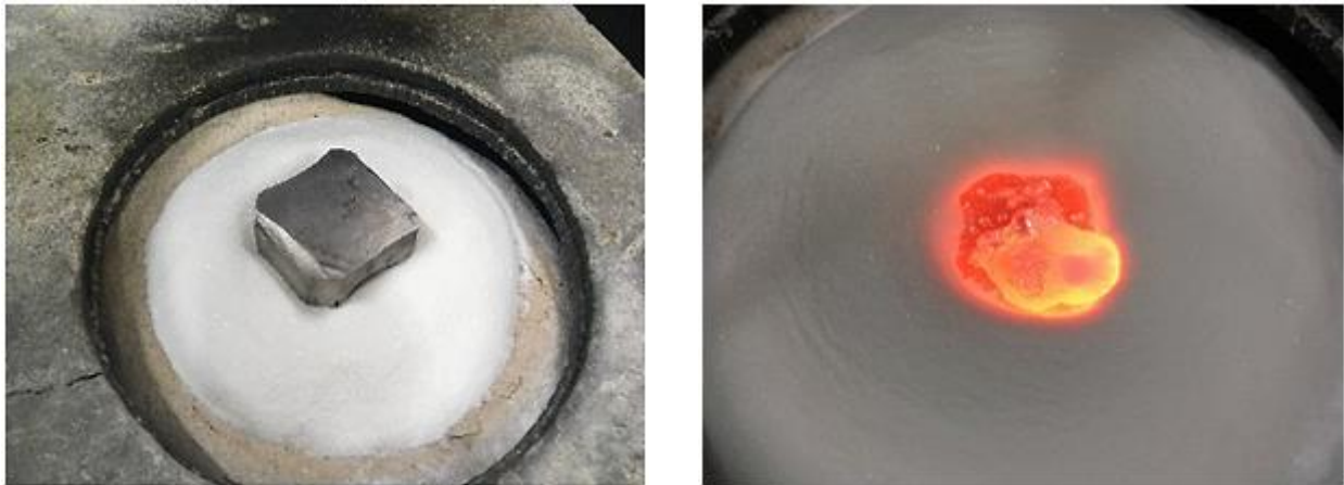
Рис. 3.2 Вид рафинируемого образца на начальном этапе очистки: а -загрузка шихты, б - процесс расплавления сплава
